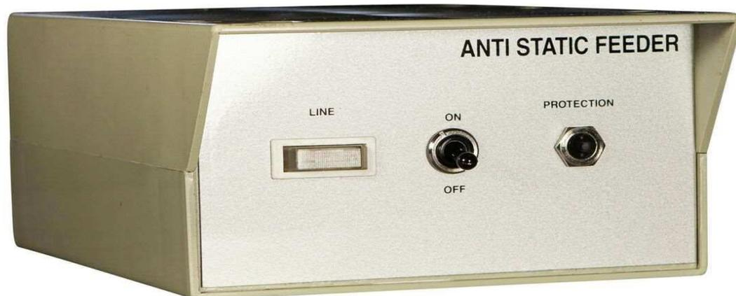
L'alimentatore **DK2** con voltaggio 8000V trasforma la tensione di rete in alta tensione per alimentare le barre antistatiche. Questo alimentatore può alimentare fino a 3 barre per un totale di massimo 6 metri di lunghezza. **DK2** si presenta munito di: interruttore on/off, indicatore luminoso per indicare la presenza di rete e disgiuntore 100 mA come protezione in caso di anomalie.
